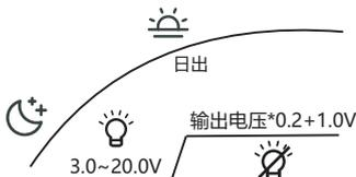
※ 1.光控点应设置为接近太阳能电池板开路电压0.22倍。
